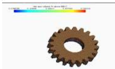
Fig. 4.10 hotspot volume above 880 c
