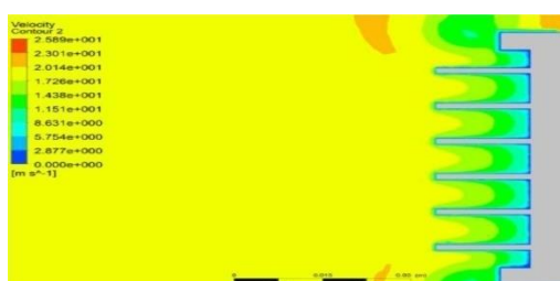
Figure20: Fin Spacing 11mm
